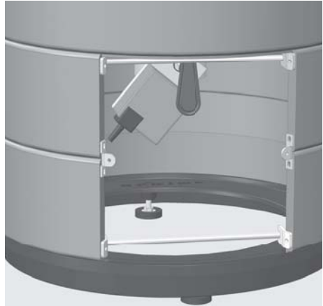
Afb. 3.2 Stelvoetjes onder de apparaatbodem, afgenomen afdekking
