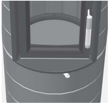
Afb. 4.4 verbrandingsluchtschuif, rechts, helemaal geopend
