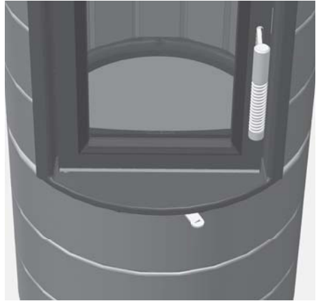
Afb. 4.5 verbrandingsluchtschuif, rechts, helemaal geopend
