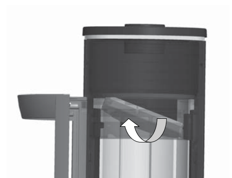
Afb. 4.19 Verwijdering van de omleidingssteen door hem zijdelings op te tillen en vervolgens eruit te kantelen
