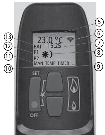
Abb. 11.2 Display-Element der Fernbedienung
