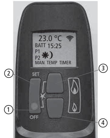
Abb. 11.1 Bedienelemente der Fernbedienung
