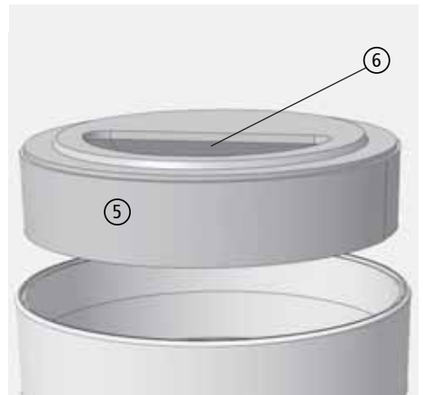
Abb. 3.7 Einlegen der ersten Speichereinlage
