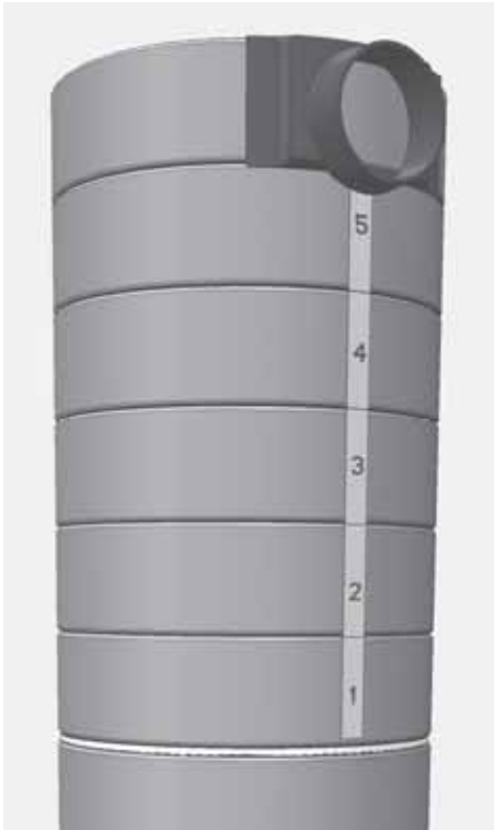
Abb. 3.1 Kennzeichnung des Aufsatzes mit hinterem Abgang
