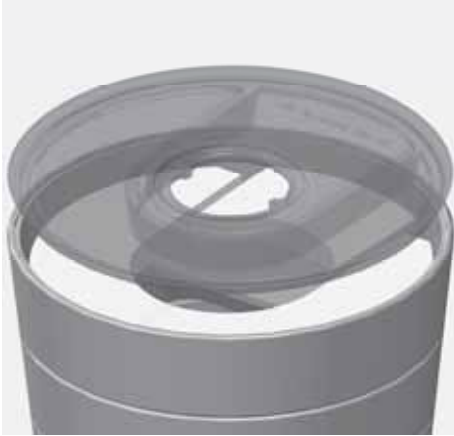
Abb. 3.17 Einlegen der Guss-Abdeckung
