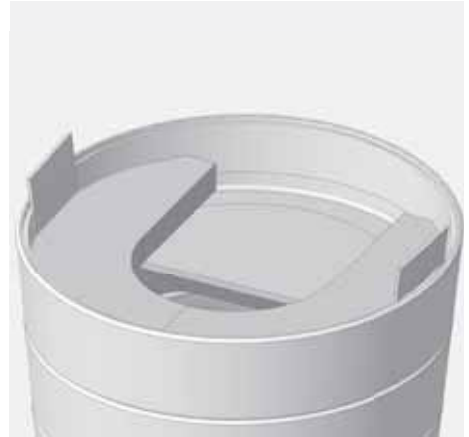
Abb. 3.15 beide seitlichen Vermiculite-Einleger eingelegt
