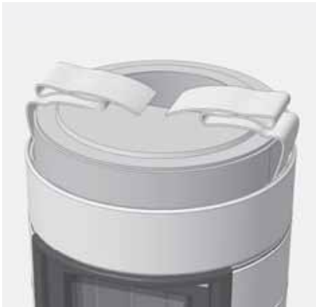
Abb. 3.11 Faservliesstreifen nach innen geklappt
