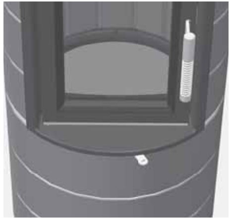
Abb. 4.4 Verbrennungsluft-Schieber, rechts, ganz geöffnet
