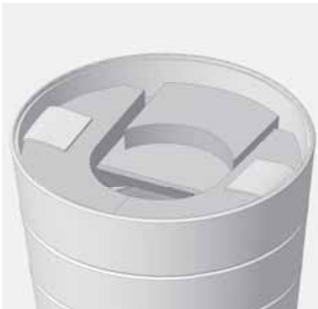
Abb. 3.16 mittlerer Vermiculite-Einleger eingelegt (nur bei oberem Abgasanschluss)
