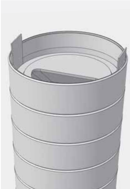
Abb. 3.14 Gussringe und Speichereinlagen vollständig aufgesetzt
