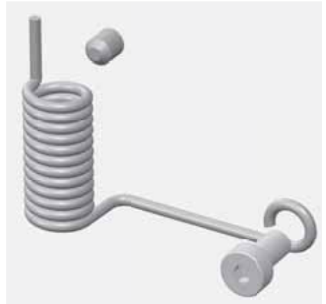
Abb. 3.6 Türfeder, Madenschraube und Spannschraube
