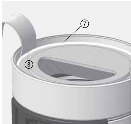
Abb. 3.9 eingelegte, umlaufende Dichtschnur
