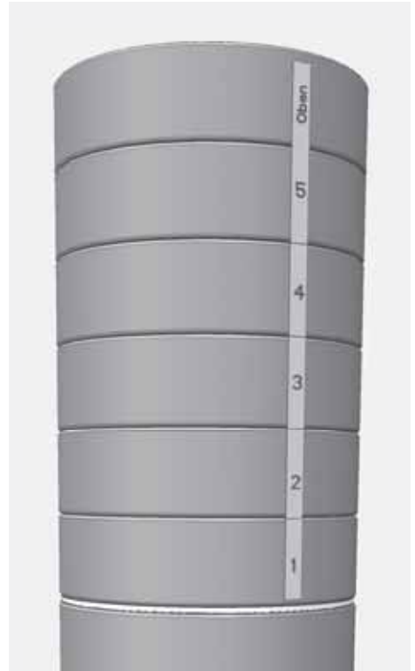
Abb. 3.2 Kennzeichnung des Aufsatzes mit oberem Abgang
