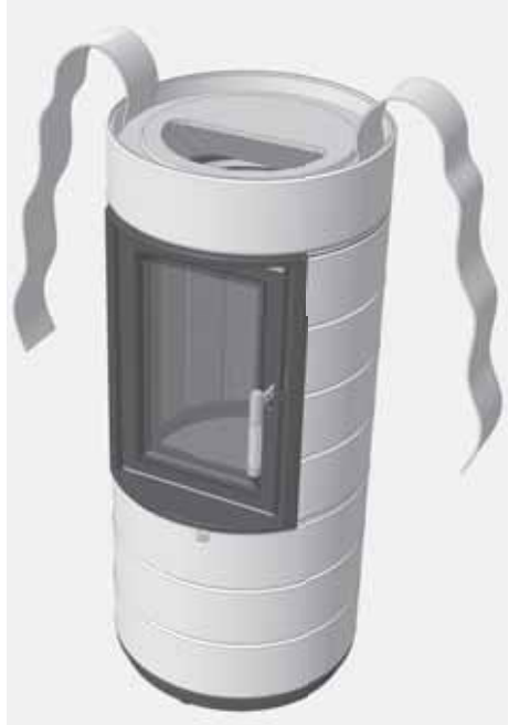
Abb. 3.8 eingeseetzte Faservliesstreifen - jeweils seitlich links und rechts
