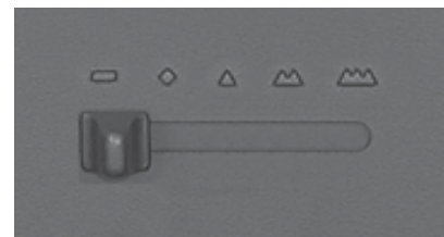
Abb. 3.5 Verbrennungsluftschieber ganz links - Verbrennungsluft ganz geschlossen
