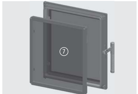
Abb. 3.14 Einbau des Dichtrahmens
