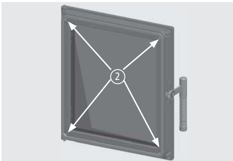
Abb. 3.9 Position der Schrauben des inneren Türrahmens
