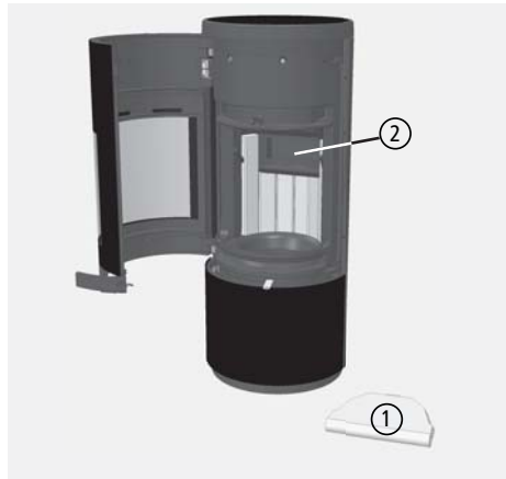
Abb. 4.22 Eintritt in den Heizgasschacht, Haltewinkel
