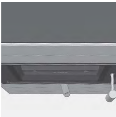
Fig. 4.4 Levier d'air de combustion complètement à droite, air de combustion complètement ouvert, allumage
