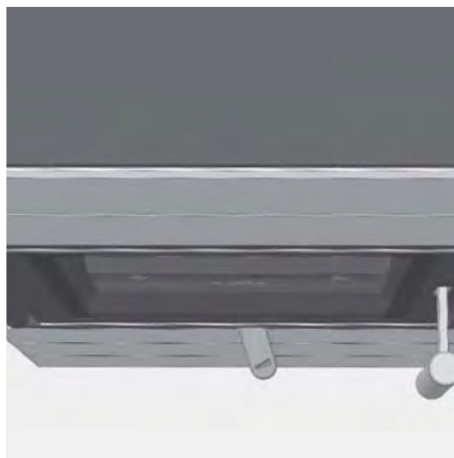
Fig. 4.6 Levier d'air de combustion complètement à droite, air de combustion complètement ouvert, allumage
