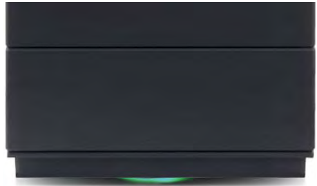
Fig. 4.16 Signal lumineux à DEL « VERT »
