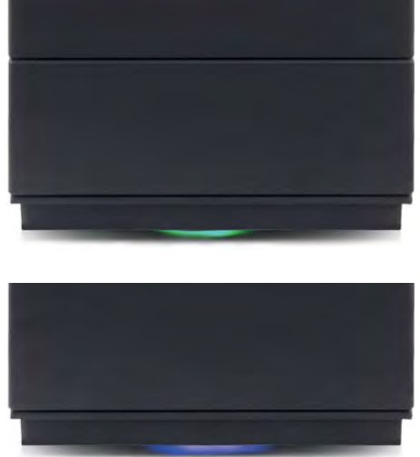
Fig. 4.24 Signal lumineux à DEL d'abord « VERT », puis « BLEU »
