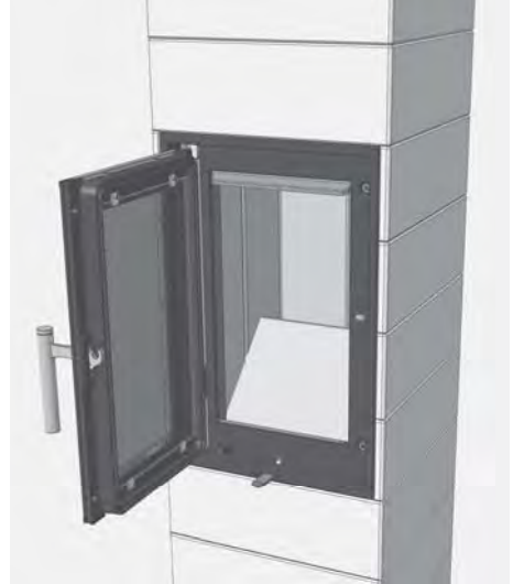
Fig. 4.28 Dépose de la brique de sole de la chambre de combustion
