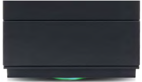
Fig. 4.22 Signal lumineux à DEL « VERT »
