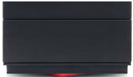
Fig. 4.27 Le signal lumineux à DEL « clignote en ROUGE » même après la combustion
