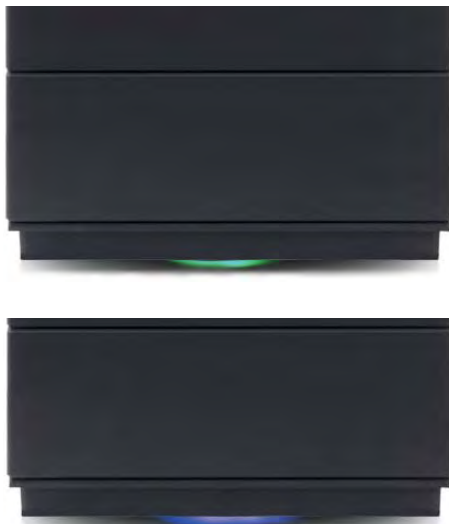
Fig. 4.18 Signal lumineux à DEL d'abord « VERT », puis « BLEU »
