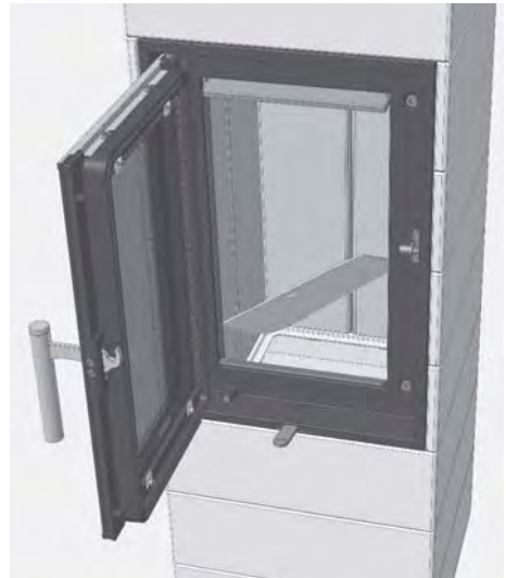
Fig. 4.29 Dépose de la plaque de fond de la chambre de combustion
