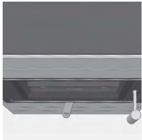
Fig. 4.7 Levier d'air de combustion complètement à gauche, air de combustion fermé
