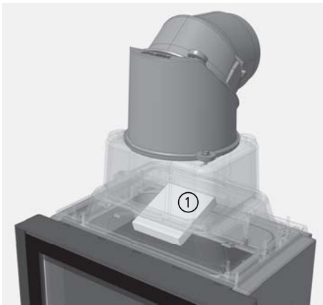
Abb. 3.15 obere Umlenkung einsetzen
