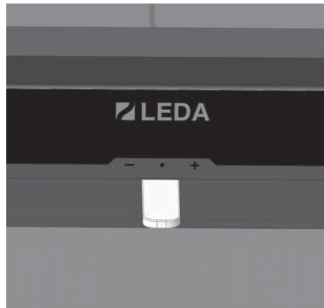
Abb. 3.5 Luftschieber mittig, Symbol „+“ Verbrennungsluft halb geöffnet
