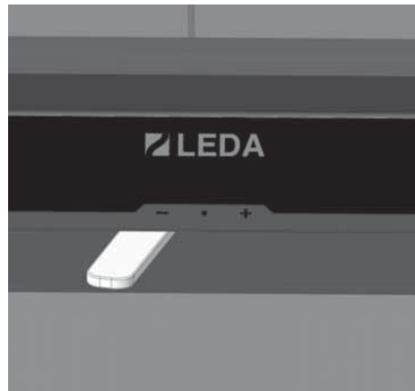
Abb. 3.13 Luftschieber ganz links, Symbol „-“ Verbrennungsluft geschlossen
