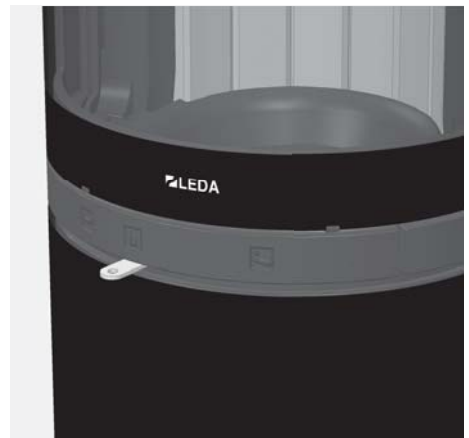
Afb. 4.10 Verbrandingsluchtschuif in het midden – normale verwarmingspositie ("nominaal verwarmingsvermogen")
