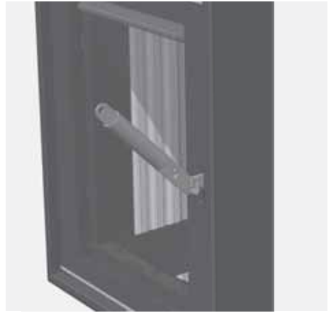
Abb. 3.2 Türverschluss und Bediengriff („kalte Hand“) bei linkem Türanschlag
