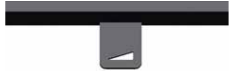
Abb. 3.9 Verbrennungsluftschieber halb rechts bis mittig
