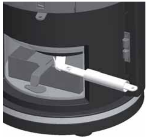
Abb. 4.8 Bedienung des Rüttelrosts mit dem Bedienhebel
