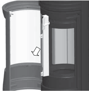
Abb. 5.4 Nur einen seitlichen Luftkanal demontieren
