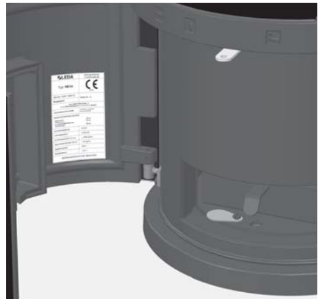
Fig. 7.3 Plaquette signalétique sur la paroi interne de la porte du tiroir à cendres
