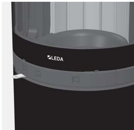
Fig. 4.11 Registre d'air de combustion poussé complètement à gauche : air de combustion complètement fermé
