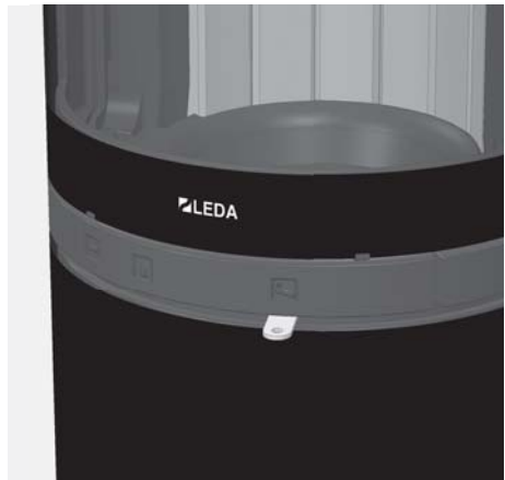
Fig. 4.8 Registre d'air de combustion poussé complètement à droite : air de combustion complètement ouvert
