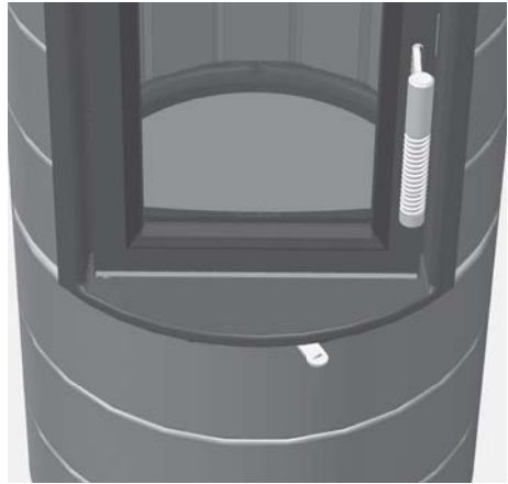
Kuva 4.4 Palamisilman säätöventtiilioikealle käännettynä, kokonaan avoinna
