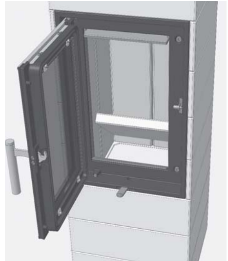
Abb. 4.13 Entnehmen des Bodensteins im Brennraum
