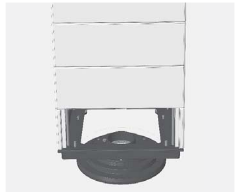
Abb. 3.13 Aufsetzen des Kaminofens auf der Drehkonsole
