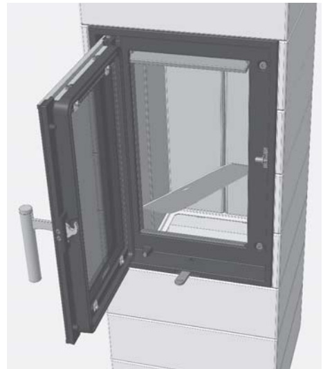
Abb. 4.14 Entnehmen des Bodenblechs im Brennraum
