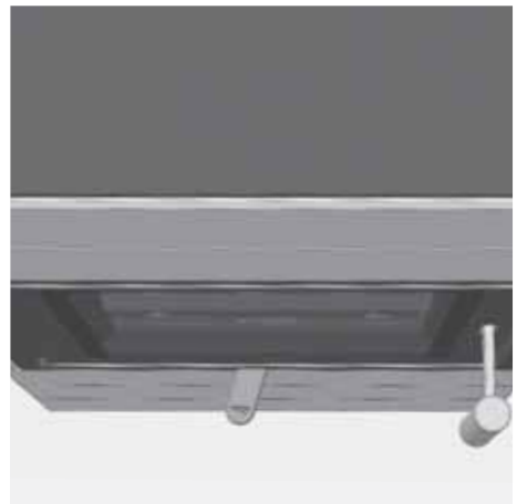
Abb. 4.7 Verbrennungslufthebel ganz links, Verbrennungsluft geschlossen
