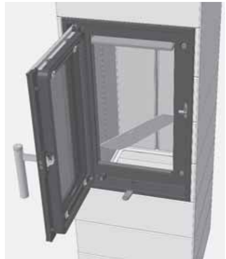
Abb. 4.14 Entnehmen des Bodenblechs im Brennraum
