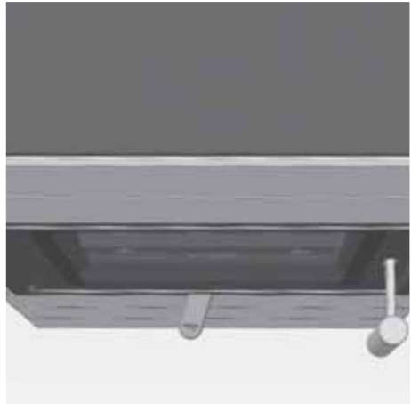
Abb. 4.3 Verbrennungslufthebel ganz links, Verbrennungsluft geschlossen
