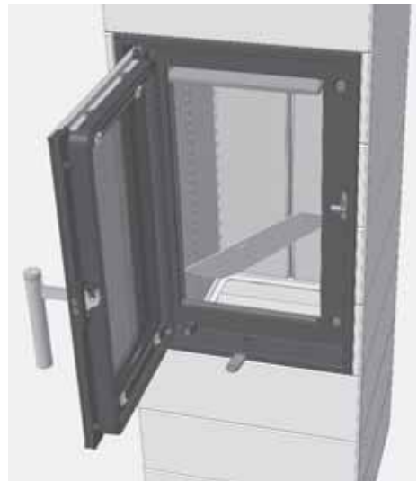
Abb. 4.29 Entnehmen des Bodenblechs im Brennraum
