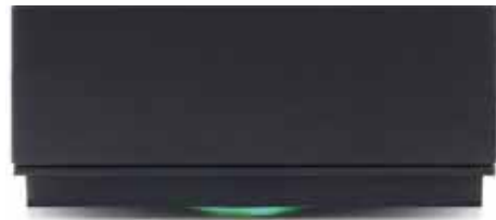
Abb. 4.26 LED-Lichtsignal bei Betrieb „ROT“ dann wieder „GRÜN“
