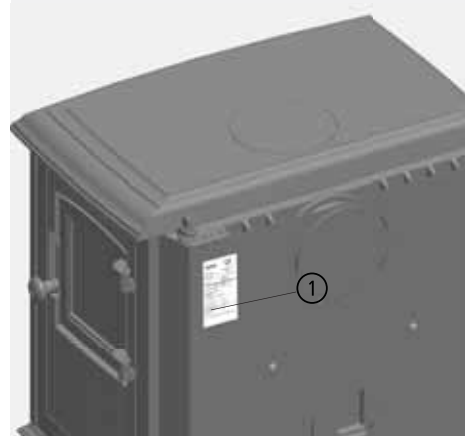
Abb. 9.1 Geräteschild / Typenschild auf der Geräterückseite
